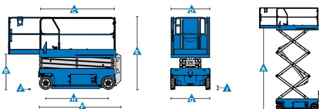
\* 公制工作高度等于平台高度加2米。英制是平台高度加6英尺。
