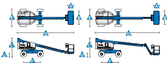
\*公制工作高度等于平台高度加2米, 英制是平台高度加6英尺
